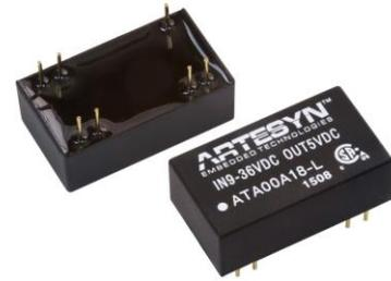
ATA 系列的各款電源轉換器都採用超寬廣的 4:1 輸入，其中 8 個型號適用於 9V 至 36V 的輸入電壓範圍，而另外 8 個型號則適用於 18V 至 75V 的輸入電壓範圍。兩類產品都另有 5 個單輸出的型號，分別提供 3.3V、5V、12V、15V 或 24V 的輸出電壓，另外還有 3 個雙輸出的型號，可提供 +5V/-5V、+12V/-12V 或 +15V/-15V 的輸出。
