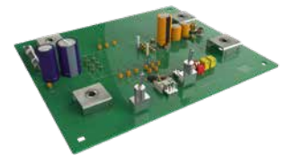
非隔离：演示板配备两个 LGA80D 模块，可测试独立通道和模块堆叠运行。
