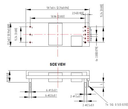
Unit: mm[inch] L=3.8±0.5mm Tolerance: X.Xmm±0.5mm[X.XX in.±0.02in.] X.XXmm±0.25mm[X.XXX in.±0.01in.]
